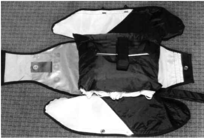
11. Verbindungsleine an der gewünschten Seite ankletten.
